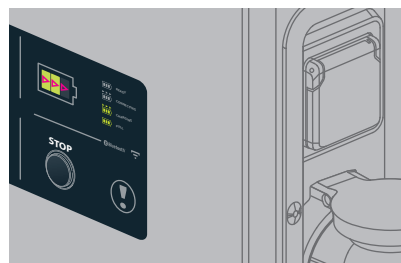
"Charge du véhicule" (défilement vert) "Vehicle charging" (green scrolling)
